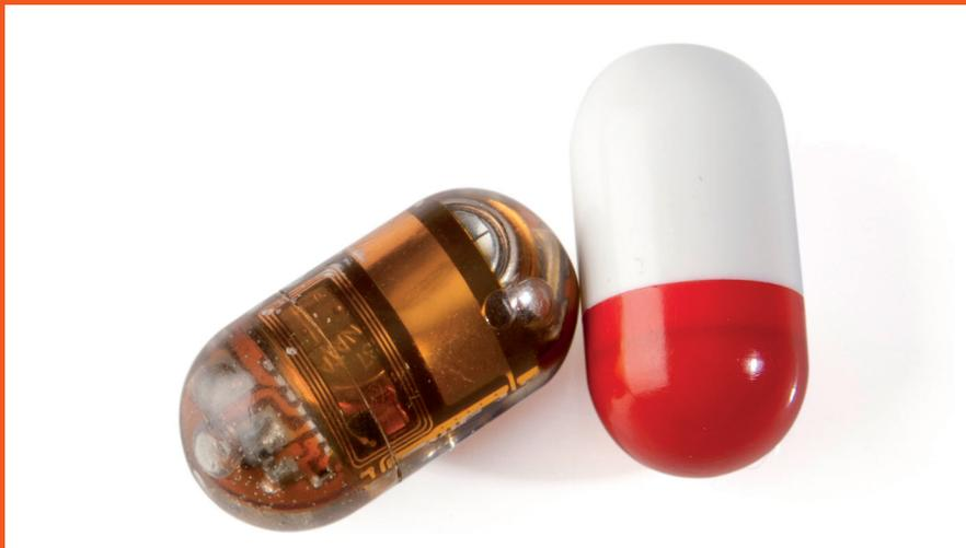
► **Le projet e-Celsius vise à développer un dispositif médical communicant pour la mesure continue, l'enregistrement et la transmission de la température centrale en situation ambulatoire, hospitalière ou dans le cadre d'une hospitalisation à domicile.**
